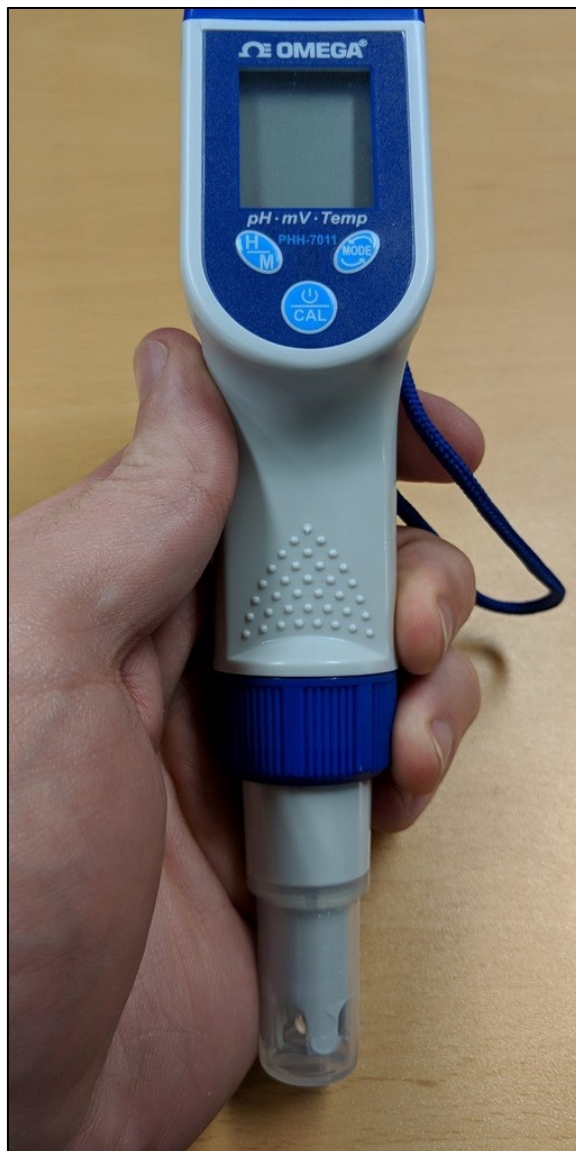
Рисунок 2: рН-метр со смачивающим колпачком. НЕ выбрасывайте смачивающий колпачок. В колпачке всегда должен быть раствор. Запасной раствор есть в комплекте рН-метра. При необходимости, его можно заказать.
