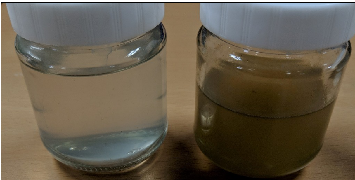
Рисунок 7: Свежеполученный раствор VpCl-649 (слева) и раствор VpCl-649, взятый непосредственно из технологического резервуара (справа) приблизительно через месяц использования.
