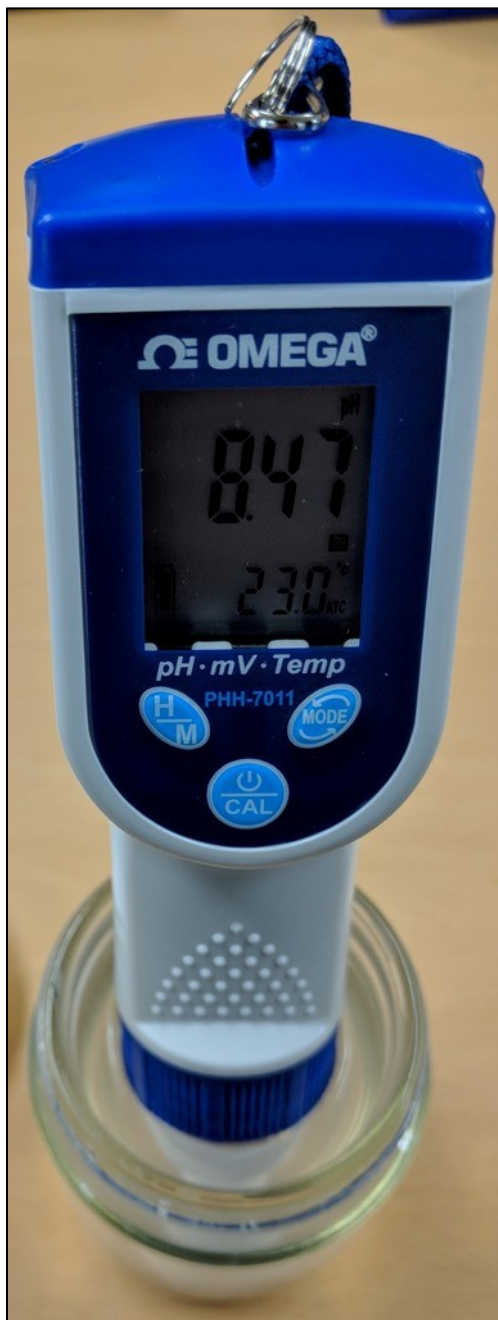
Рисунок 3: Измерение pH (8,47) полученного раствора VpCl-649. Обратите внимание, что данный результат измерения действителен только для данной смеси. Результаты измерения будут разными в зависимости от pH источника воды в разных местах нахождения.
