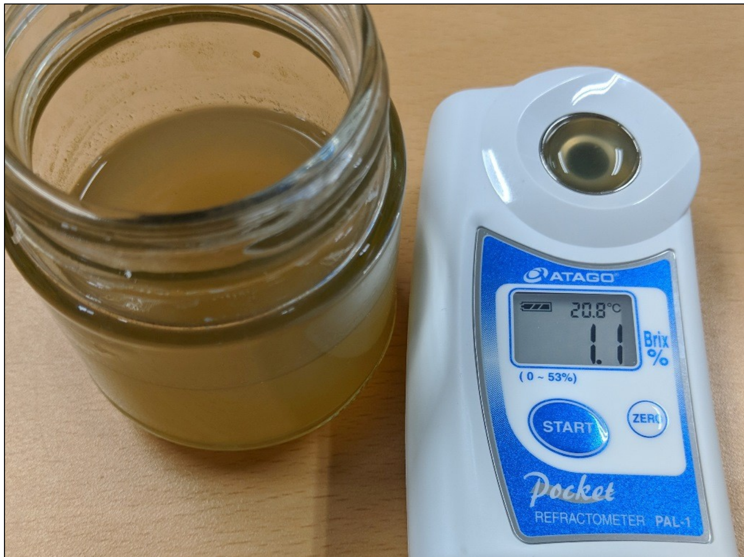
Рисунок 8: Показатель преломления использованного раствора VpCI-649. Несмотря на значительные изменения цвета, показания рефрактометра значительно уменьшились по сравнению с первоначальными показаниями (1,5), что говорит о снижении концентрации VpCI-649.
