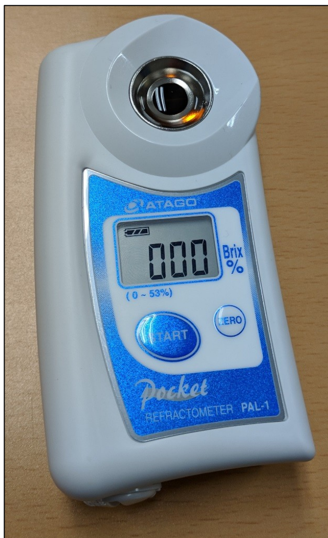
Рисунок 5: После нажатия на клавишу ZERO (НУЛЬ) на дисплее отображается 000. Это значит, что прибор установлен на ноль и готов к использованию.
