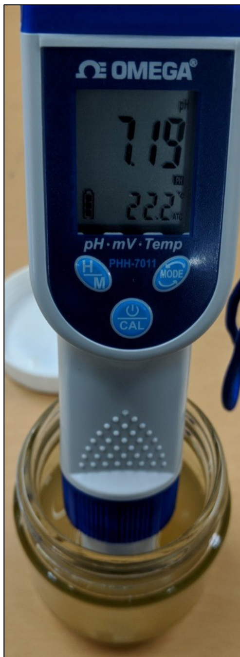
Рисунок 9: Уровень pH использованного раствора VpCl-649. Уровень pH значительно снизился по сравнению с начальным показанием (8,52), что говорит о поступлении жидкости / воды с низким уровнем pH и снижении концентрации VpCl-649.
